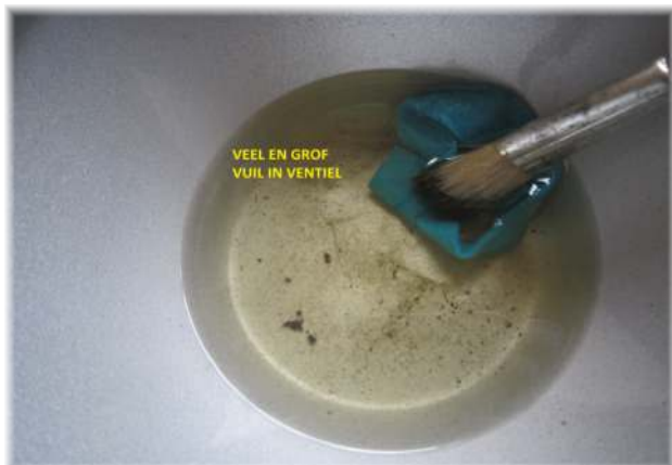
Spoelvloeistof uit een defecte servoklep. Moet u nog raden naar de storingsoorzaak?
